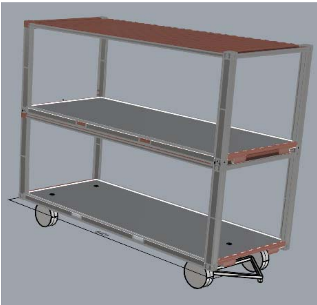
Forslag til ny Blå vogne baseret på 20' container. Dobbelt hjulpar der giver mulighed for tungere last.
